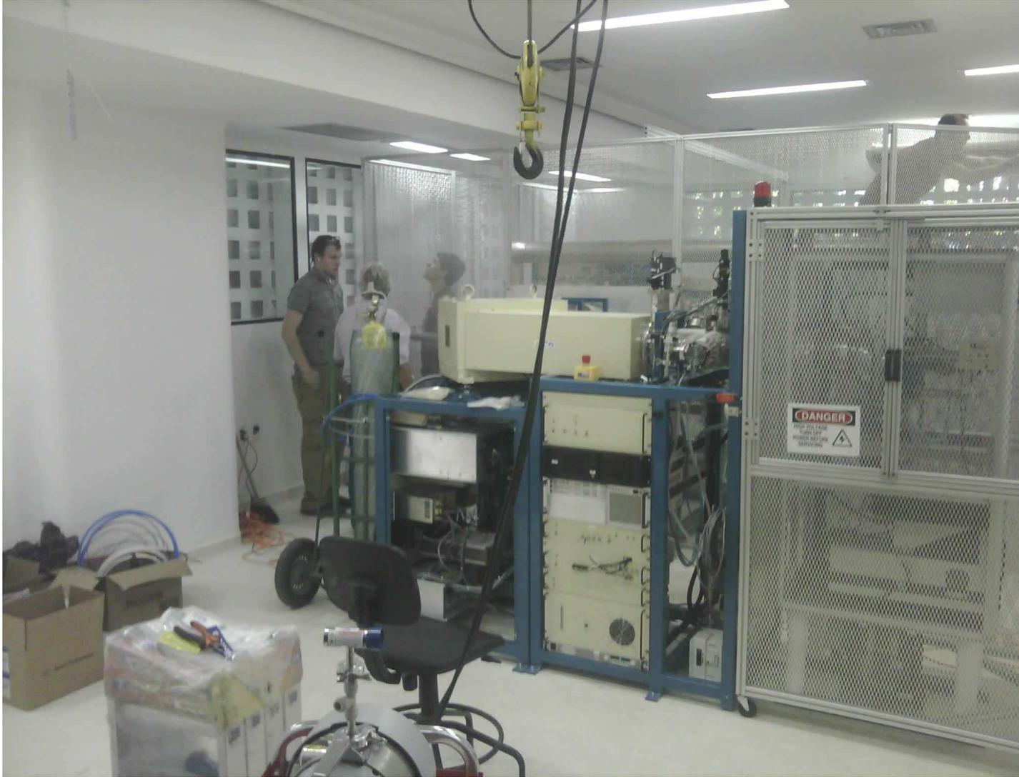
Acelerador sendo instalado no laboratório AMS.
